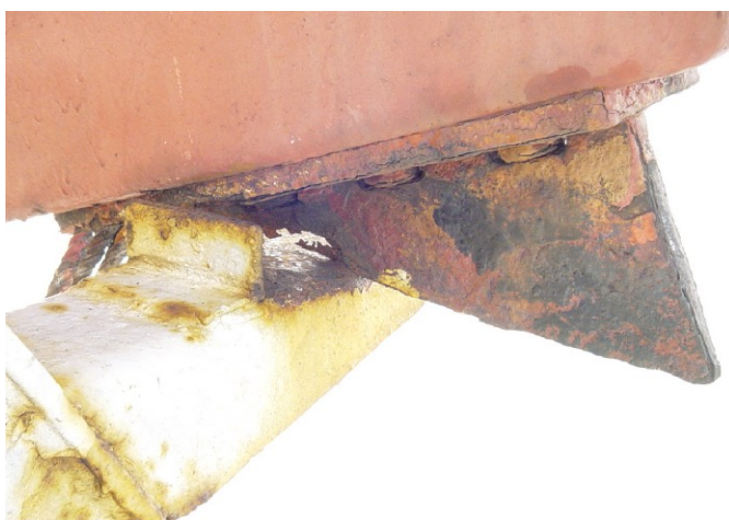
救生艇底托锈蚀严重
